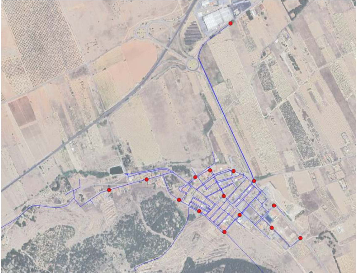
Figura 47. Colectores a sustituir. Actuación 5.1
