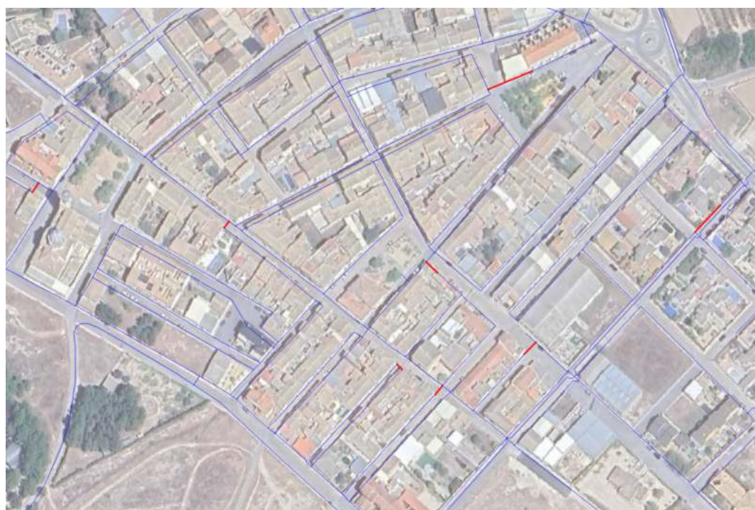
Figura 48. Ejecución 8 nuevos tramos para cerrar mallas. Actuación 7.1.
