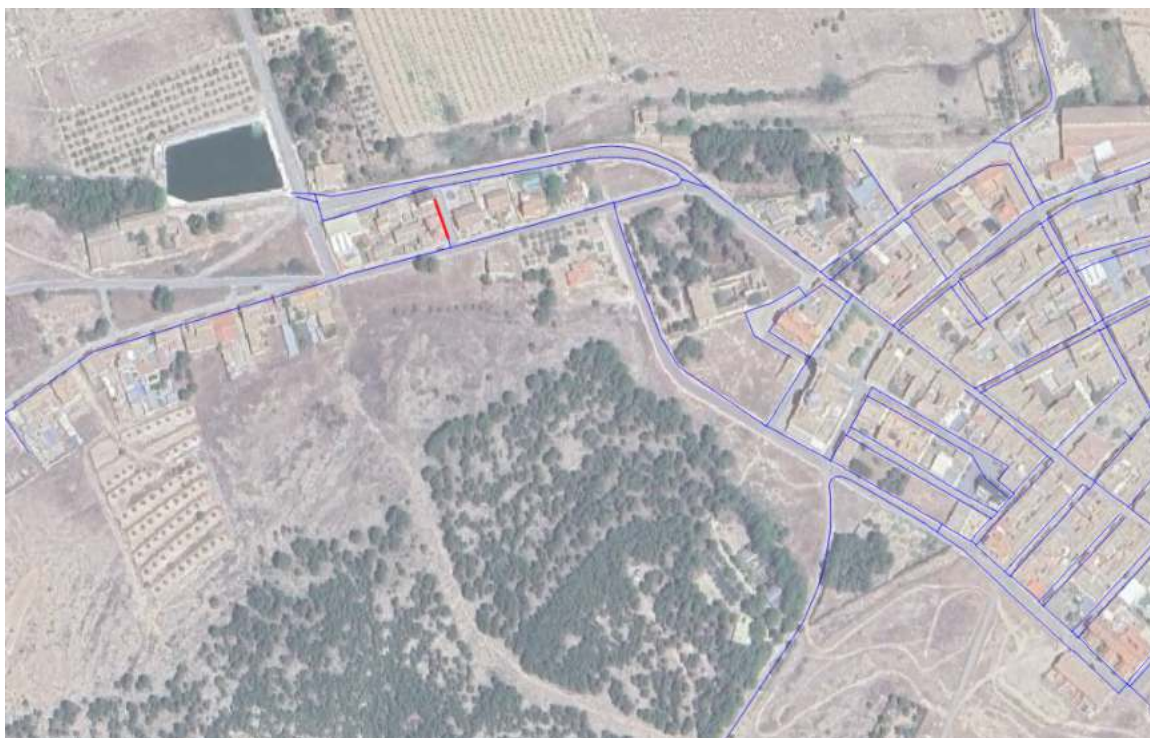
Figura 47. Colectores a sustituir. Actuación 4.3
