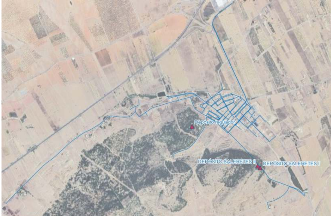
Figura 14. Depósitos de la red de abastecimiento de Campo de Mirra.
